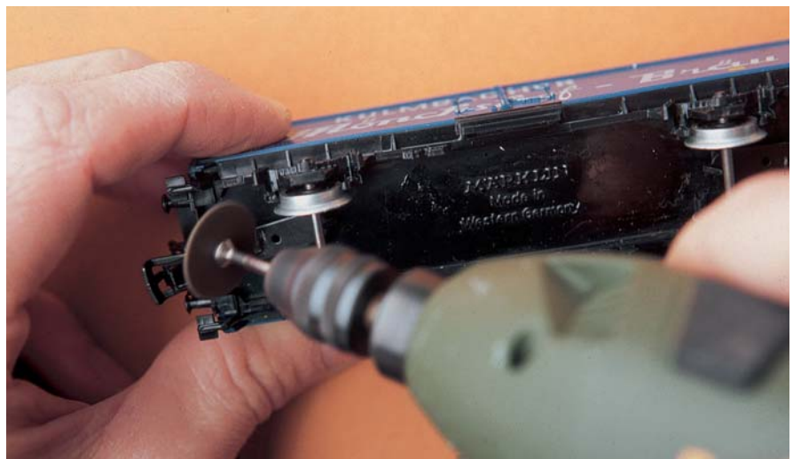
Die Kupplungsdeichsel-Befestigungs-Niete wird durchgetrennt. Am besten wählt man für diese Arbeit eine Trennscheibe mit kleinem Durchmesser, um einer Beschädigung von Fahrzeugteilen vorzubeugen
