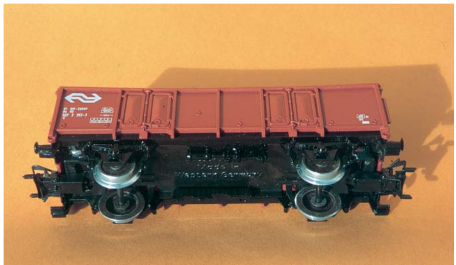
Der Kurzkupplungs-Umbau wurde an diesem offenen Wagen erfolgreich abgeschlossen. Nun kann auch hier eine farbliche Detailbearbeitung folgen
