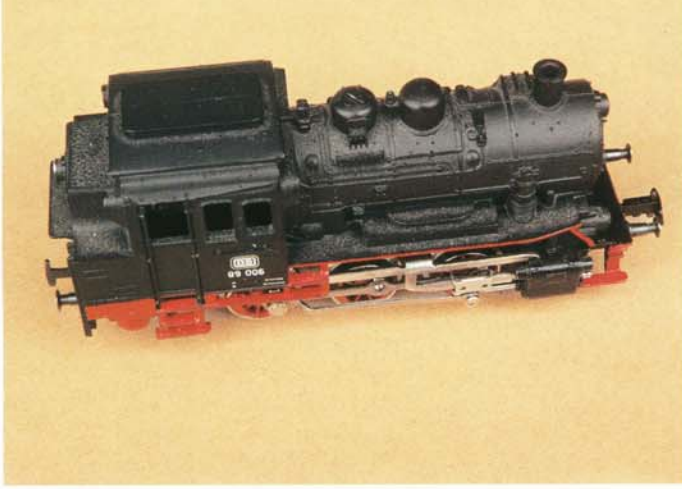
An dieser 89-er ist vorne bereits die Prallplatte aufgesteckt. Hinten ist noch der „nackte“ Kupplungshaken erkennbar
