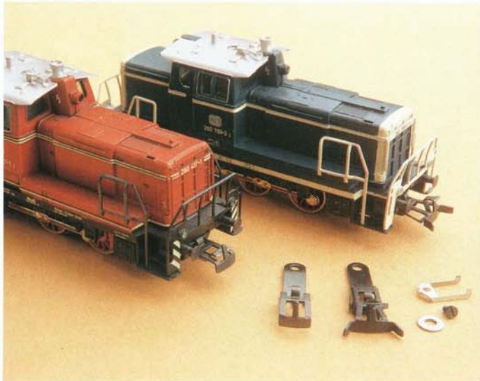
Die Baureihe 260, rechts noch vor, links nach dem Umbau. Zum Vergleich auch je eine alte und neue Kupplungsdeichsel
