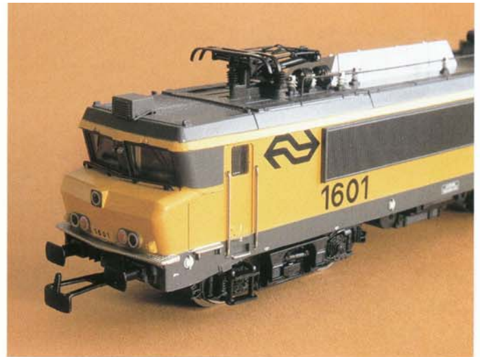
Der Kupplungshaken an dieser holländischen E-Lok kann gegen die Kupplungsdeichsel 404020 getauscht werden
