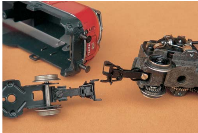
Für Lauf- und Treibgestell wird je eine Kupplung aus 7205 unterschiedlich bearbeitet. Die Pufferbohle des Gehäuses befindet sich hier noch im Originalzustand
