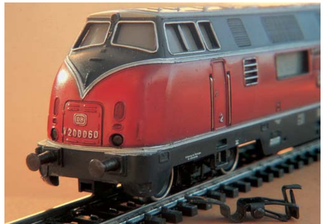
Hier wurde die Vorentkupplung gegen einen Schacht 288390 getauscht. Diese Variante ist allerdings nur in Sonderfällen zu empfehlen
