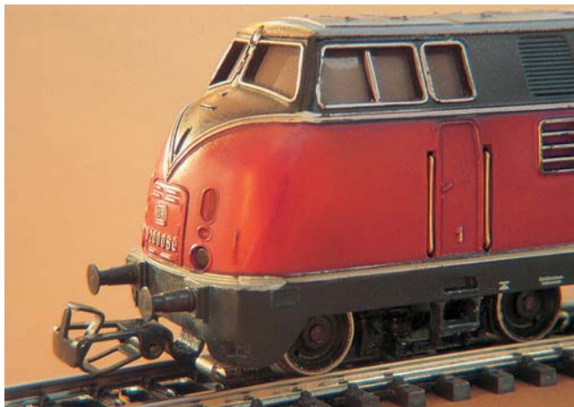
Die große Pufferbohle an der V200 erforderte für dieses Modell eine RELEX-Vorentkupplung in Sonderbauform
