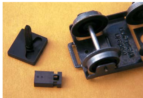
Die Auswahl ist getroffen: Für den Umbau liegen SYMOBA-Kulisse 111 und Schacht 110 bereit. Das Tiefladewagen-Fahrgestell ist fertig bearbeitet
