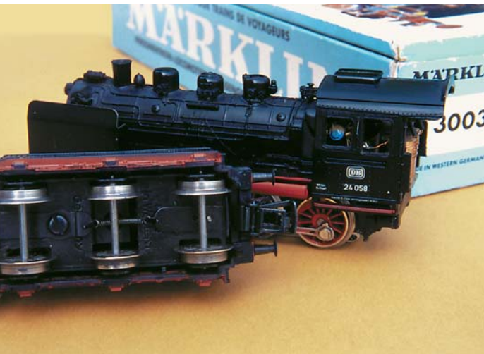
Am Tender der Dampflok BR 24 entdeckt man das gleiche Fahrgestell wie beim Tiefladewagen. Dies legt auch hier den Einbau einer Kurzkupplungskulisse nahe
