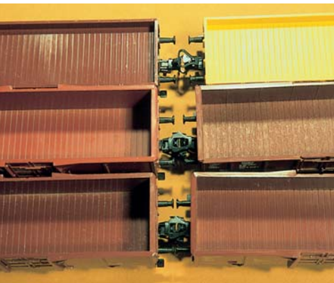
Der Längenvergleich zeigt von oben nach unten: serienmäßige Relax-Kupplung, Kurzkupplung aus 7205 und Kinematik-Kurzkupplung mit Symoba-Umbau
