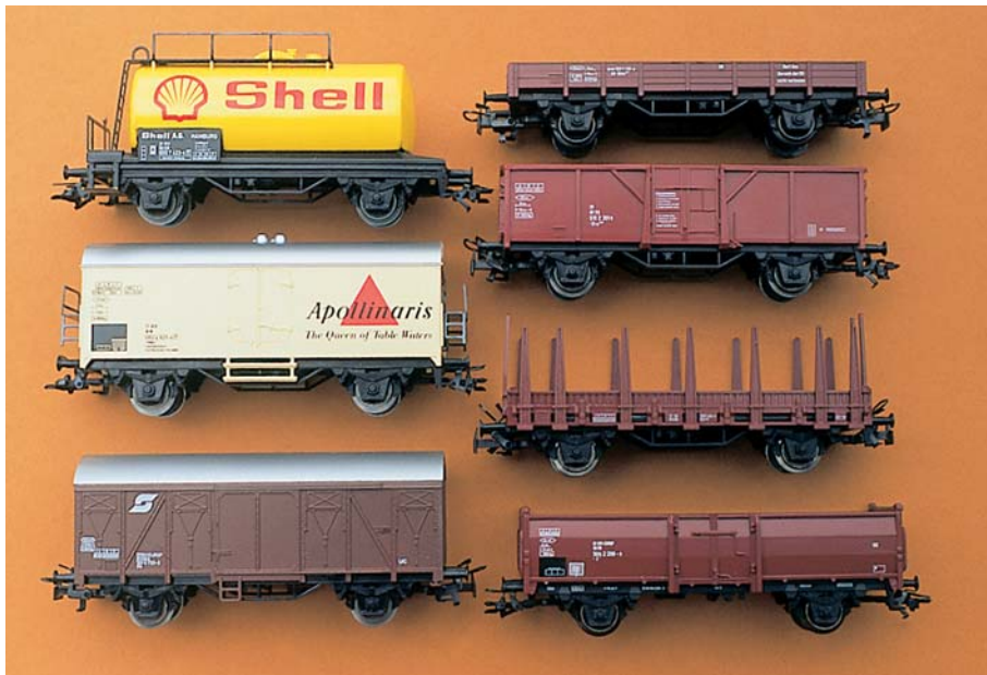
Eine Auswahl zweiachsiger Güterwagen mit Drehpunkt-Befestigung: Alle abgebildeten Modelle besitzen das 11,5 cm lange Fahrgestell und eignen sich daher für beide Umbau-Varianten
