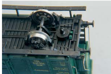
Das Bühnen-Fahrzeugende des Württembergischer Güterwagens 4679 von unten gesehen. Deutlich ist die überstehende Pufferbohle erkennbar.
