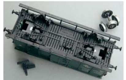
Wagen-Zusammenbau vor dem Einkleben. An beiden Enden unterschiedliche Montageabstände der Kinematik. Die erhaltenen Spreizankerungen fixieren Gehäuse und Beschwerung ohne Kleber.
