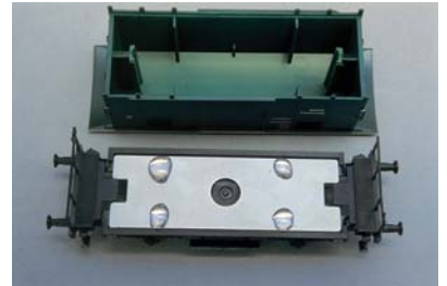
Beschwerung und Bühnen sollten bereits stabil festgeklebt worden sein, bevor die Klebstofftropfen zur Gehäusefixierung aufgebracht werden.
