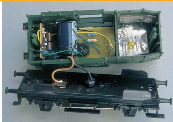
Vor dem Aufsetzen des Gehäuses: Die Lichttechnik-Elemente passen noch gut in den Packwagen 4699. Der Text erläutert die Kabelfarben.
