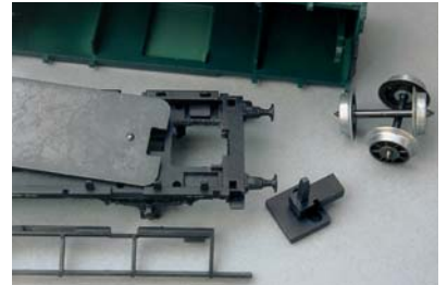
Hier wurde der Wagenboden bereits ausgesägt. Insbesondere für den Betrieb auf Metallgleisen sollte man etwas mehr Kuppelabstand vorsehen.
