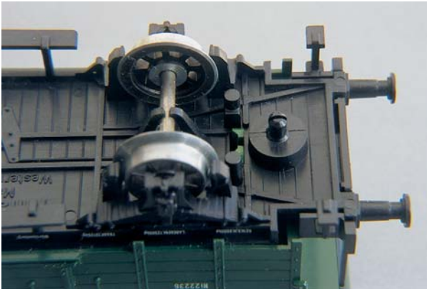
Betrachtet man den Wagen 4685 von unten, so stellt man fest, dass die Aufbau-Spreizverankerung genau an dem für die Kulisse erforderlichen Einbauort liegt.
