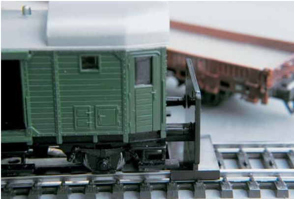
Umbau gemäß Justiereinheit: Die Puffer berühren die Platte. Bei diesem Modell ist keine Längenzugabe erforderlich.
