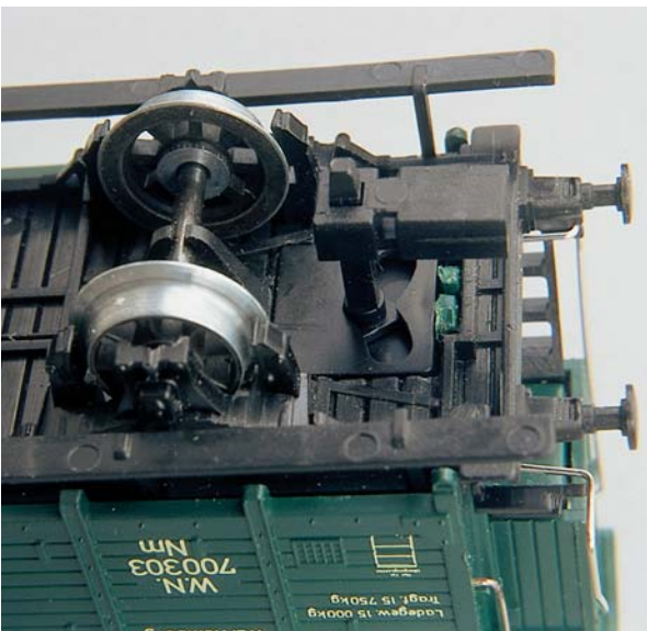
Die Kulissenführung stößt an die Gehäuse-Spreizkrallen. Vor dem Zusammenbau ist zu prüfen, wie viel von diesen ggf. abzuschleifen ist.
