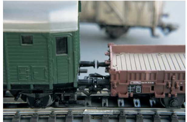
Die serienmäßige Rungenwagen-Kulissenführung lässt etwas mehr Luft als andere Wagen und bildet daher nicht immer die optimale Vergleichsdistanz!
