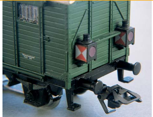
Hinten wurde einfach eine Kupplung aus der Packung 7205 eingesetzt. Die Schlusslicht-LEDs schließen plan mit der Laternen-Rückseite ab.
