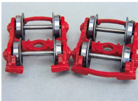
Beide Umbauvarianten erfordern das Herauslösen des hinteren Fahrgestellverbindungsstegs.
