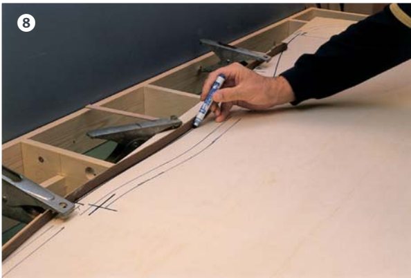
8 Eine elastische Holz- oder Kunststoffleiste hilft den gewünschten Bogenverlauf im Flexgleis-Bereich anzuzeichnen. Markiernadeln oder 20-er-Nägeln halten die Leiste in der vorgesehenen Krümmung fest.
