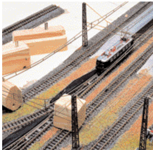
Montagehilfe: Ein Holzklötzchen mit zwei Nägeln auf der Stirnseite hält den Fahrdraht in Lötposition.
