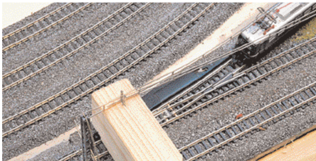
Der Übergang zur freien Strecke: Vom Bahnhof aus wird die Leitung weitergeführt. Die Distanzklötzchen mit den eingeschlagenen Nägeln halten den Fahrdrabt exakt in der vorgesehenen Lötposition.
